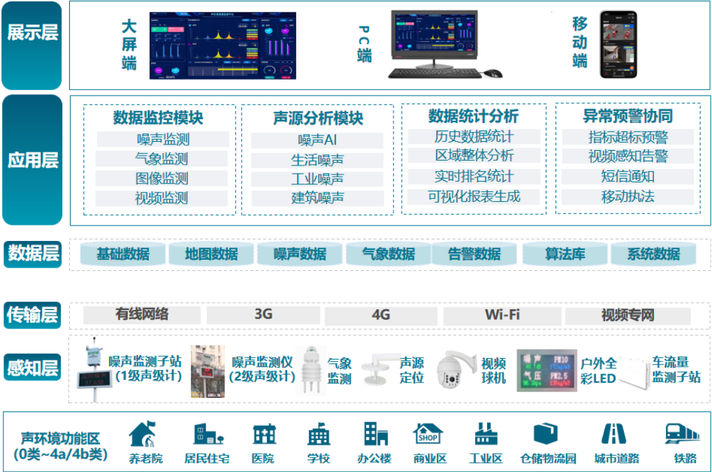
图 1 功能区声环境在线监测系统构成
