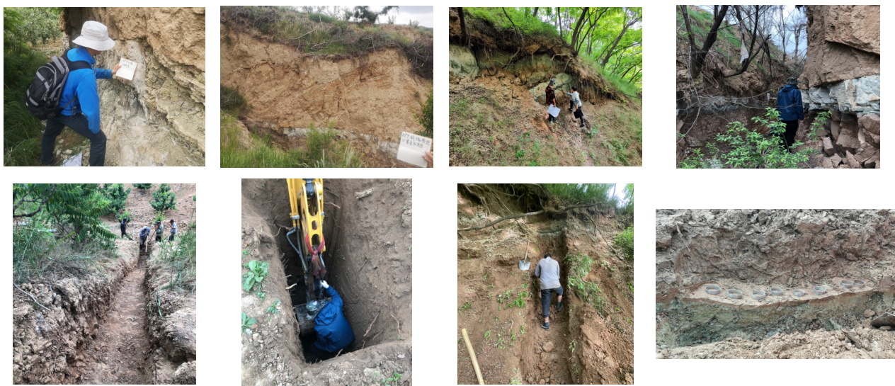
图1 沟探、坑探在滑坡勘查中应用
