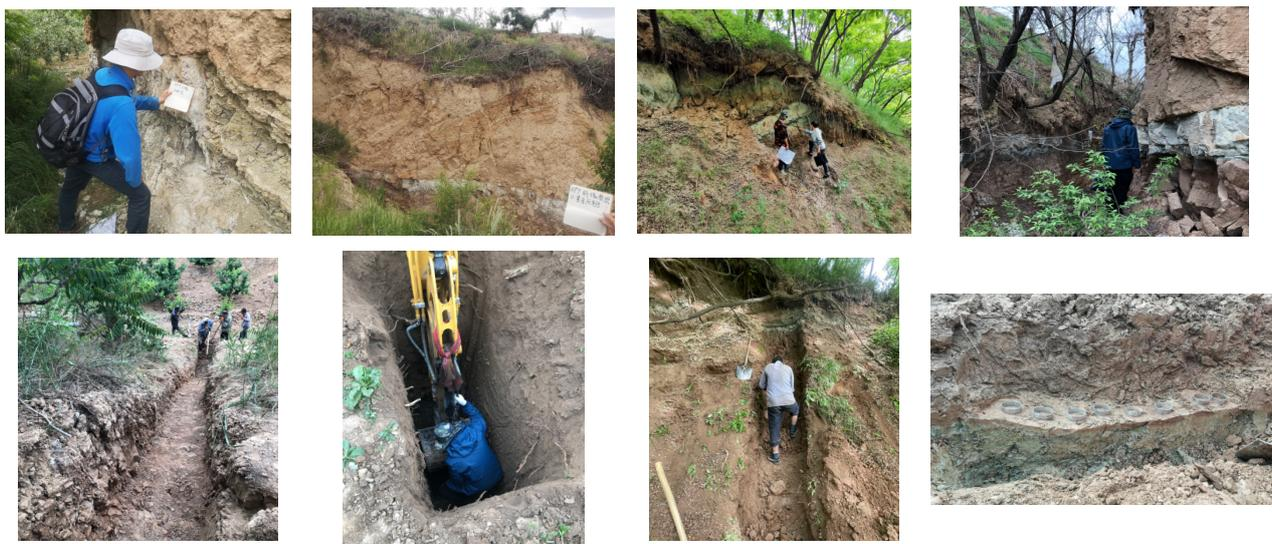
图1 沟探、坑探在滑坡勘查中应用
