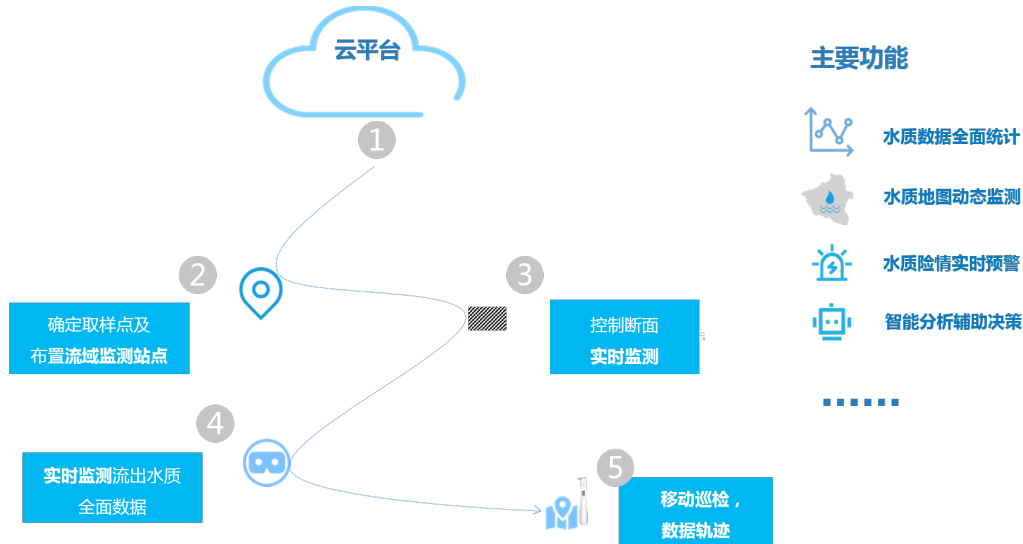
图 1 基于云平台的地表水实时监测系统
