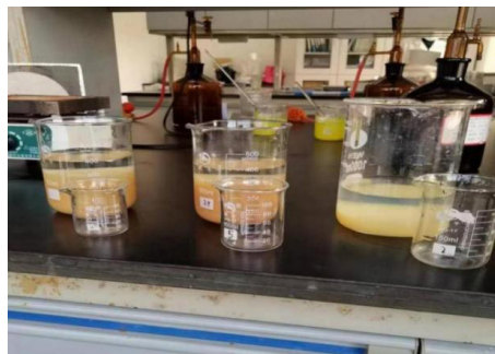
图 1 \text{FeCl}_3 溶液 1%，pH=4.3 和 pH=6.75 的对比实验
