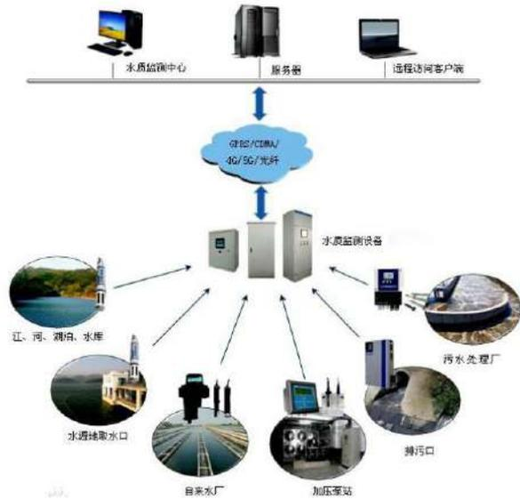
图2 水质自动监测平台的构成
