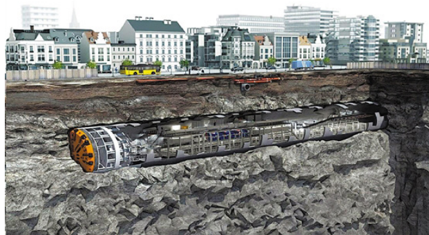
图1 盾构机——挖掘地铁隧道的“铁蚯蚓”
