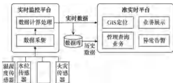
图 1 地下管线监控系统
