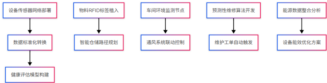
图 1 物联网技术在智慧工厂中的多层级应用架构图
