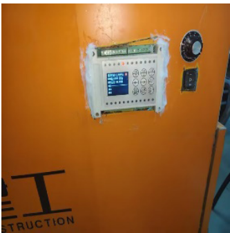
图 24 土方压实机器人 plc 控制系统
