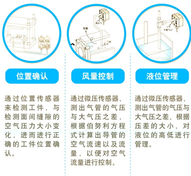
图 1 压力传感器工作原理
