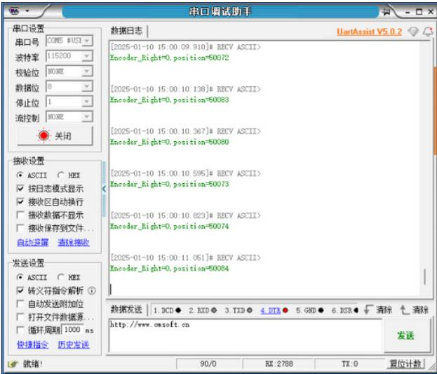
图 4 光电编码器输出图
