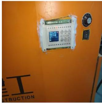
图 24 土方压实机器人 plc 控制系统
