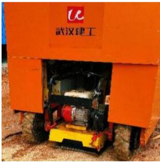
图 23 土方压实机器人
