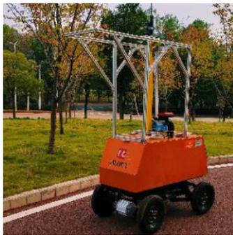
图 26 矩阵式钻孔机器人
