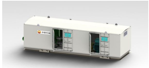
图 1 无人值守返排液泵橇定型三维效果图
