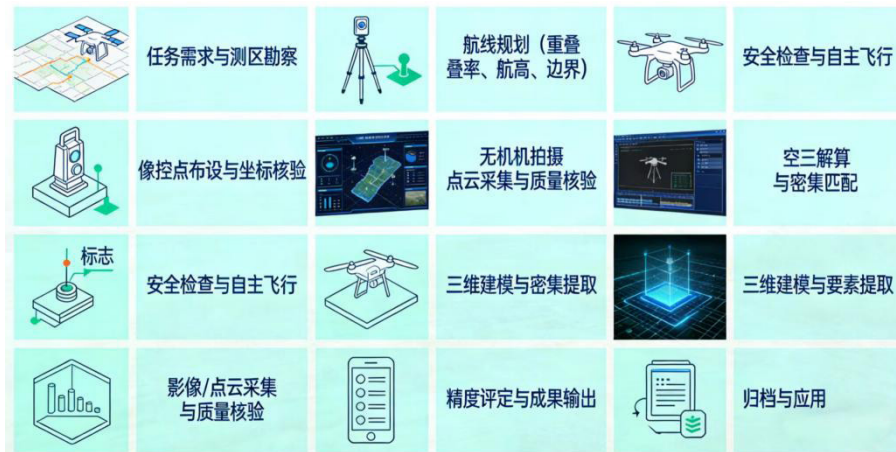
图 1 无人机测绘标准作业流程
