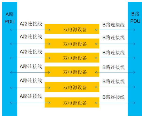
图1 双电源设备柜内布线示意图
