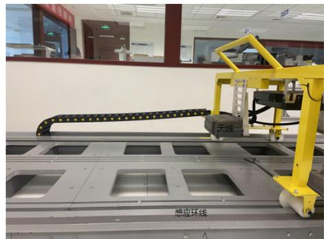
图 9 车载发送天线测试环境搭建
