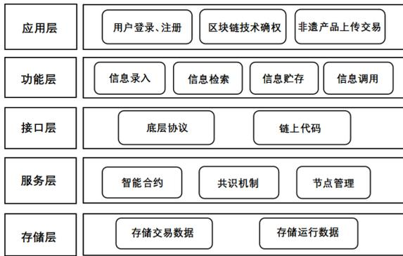
图 1 区块链系统架构设计图
