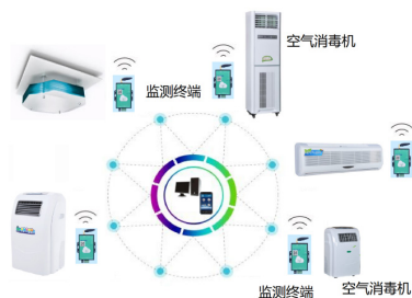
图2 全域空气消毒机监测系统示意图
