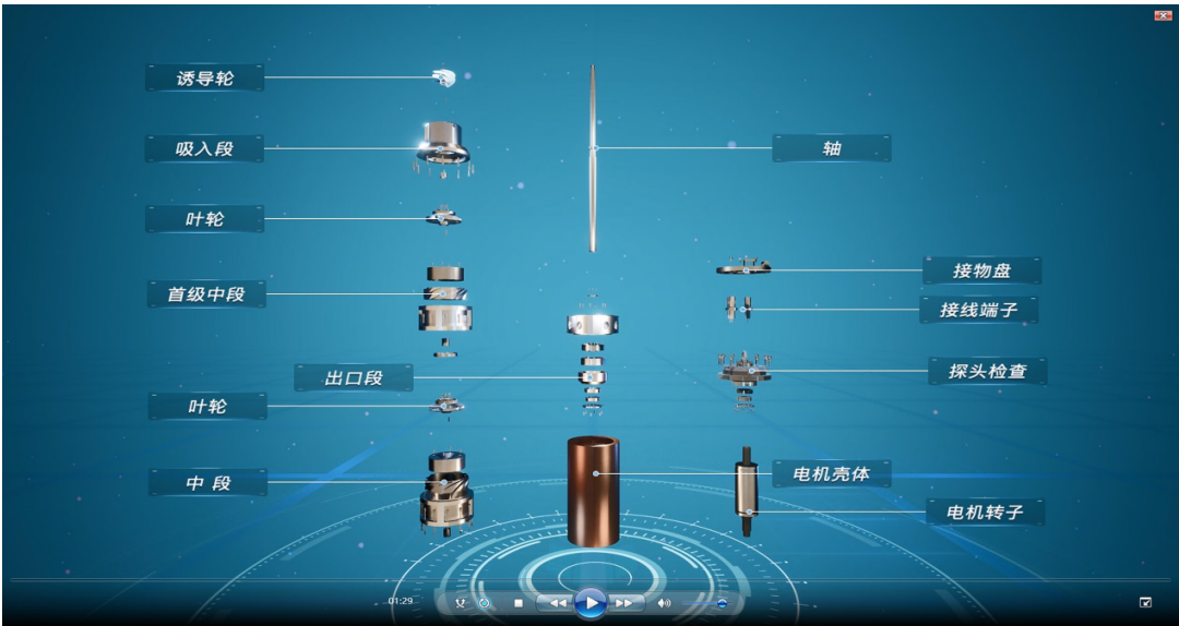
图 5 低压泵设备零部件级拆解示意图
