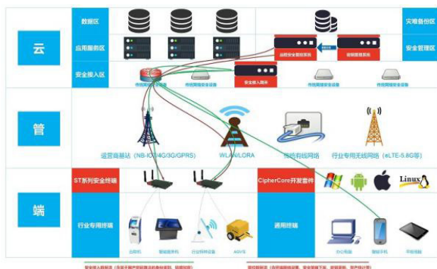
图 1 无线网络云管端保护机制流程
