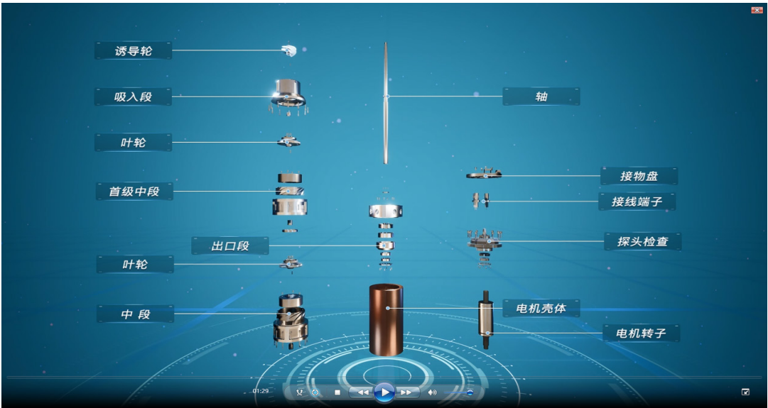
图 5 低压泵设备零部件级拆解示意图
