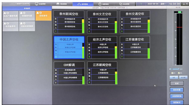
图3 泰州广电无线发射台智能监控系统监听频率选择界面
