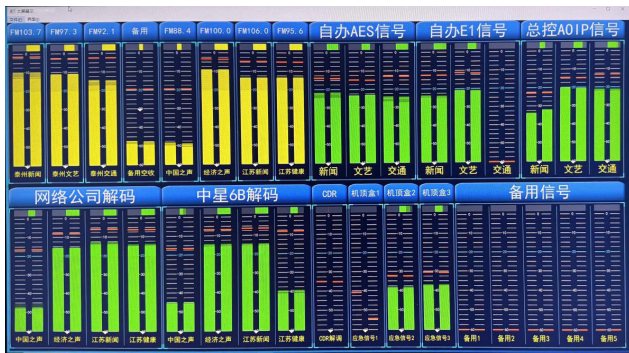
图2 泰州广电无线发射台智能监控系统的空收信号和信源信号监测界面
