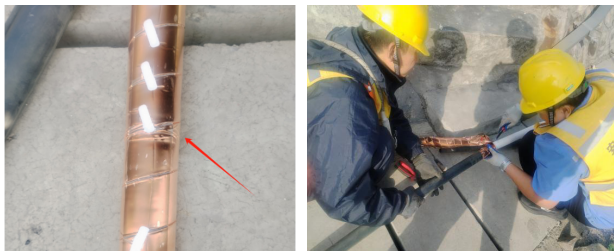
图1 故障漏缆外导体变形褶皱示意图
