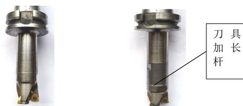
(a) 深度≤80mm采用 (b) 深度≥80mm增加刀具加长杆标准铣刀
