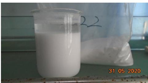
图5 装置内盐酸酸化后苯基胍
