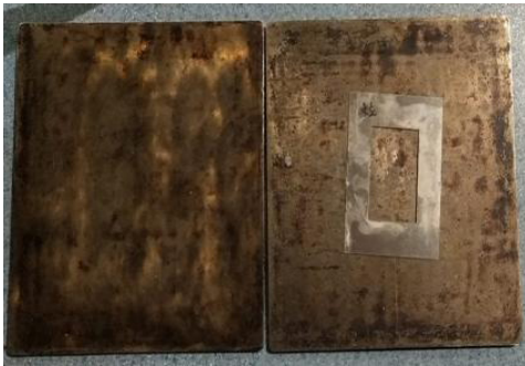
图 2 溢料式模具及 0.2mm 模具
