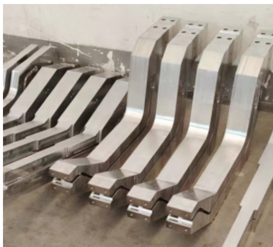
图 5 电气设备铝臂局部镀镍
