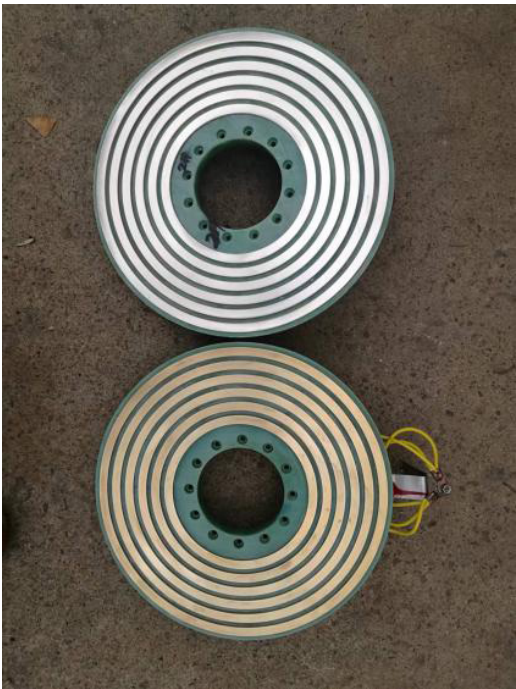
图 2 CT 电气设备中的环槽镀银铈合金前后对比
