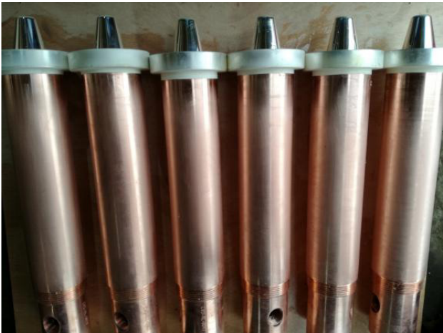
图 3 还原炉电气设备电极镀银
