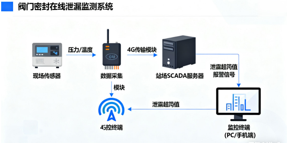
图 2 阀门密封在线泄漏监测系统架构
