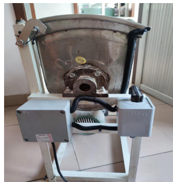
图 4 安装测试好后的正常使用状态 (侧面) (设置开盖联锁保护装置)
