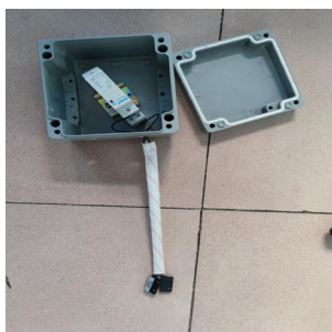
图 3 前置控制电路组合、配套铝质防爆盒
