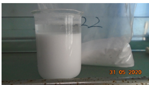
图5 装置内盐酸酸化后苯基胍
