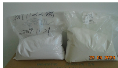
图 1 2019 年 11 月 21 日格品苯基胍(左)与 2020 年 1 月 14 日不合格品苯基胍(右)颜色对比
