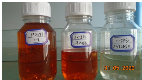
图4 活性炭脱色后加成液颜色（左：工业使用活性炭脱色；中：小批量采购活性炭脱色；右：10倍小批量采购活性炭脱色）
