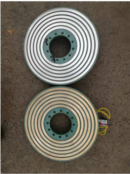
图 2 CT 电气设备中的环槽镀银铋合金前后对比
