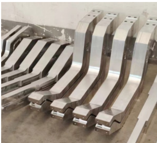
图 5 电气设备铝臂局部镀镍
