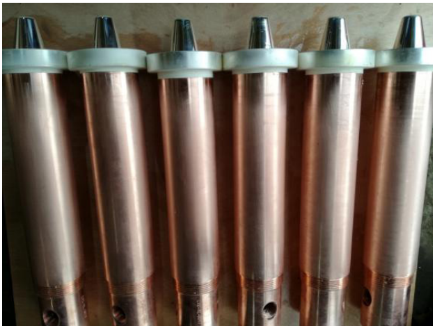
图 3 还原炉电气设备电极镀银
