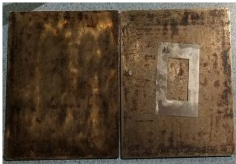
图 2 溢料式模具及 0.2mm 模具
