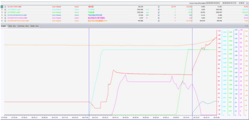
图 6 H 级机组热态启动曲线
