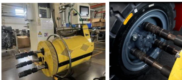
图2 轮胎安装螺母拧紧设备
