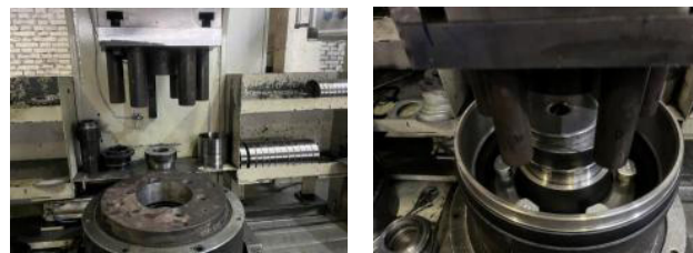
图4 螺栓压装工艺装备
