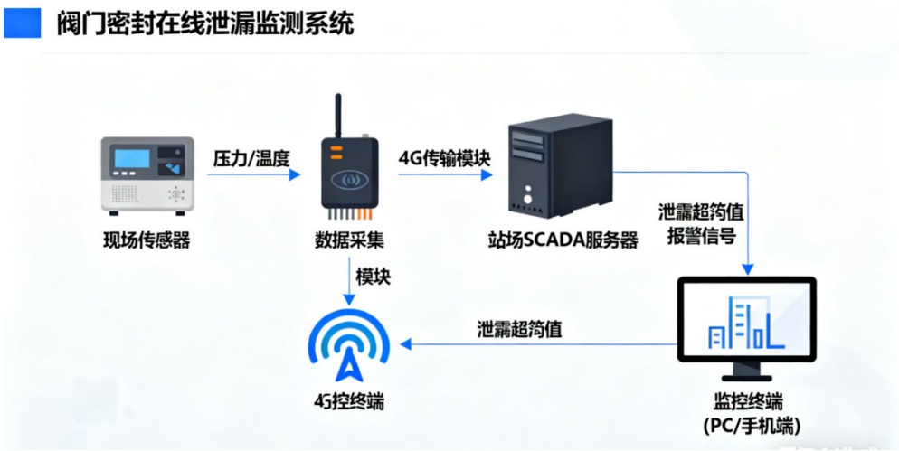
图 2 阀门密封在线泄漏监测系统架构
