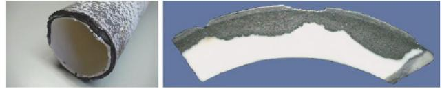
图 2 陶瓷输送辊与 AISi 涂层板的粘连与侵蚀
