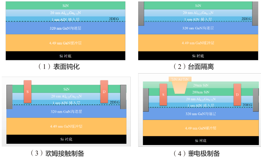
图 1 GaN 基电力电子器件基本工艺流程
