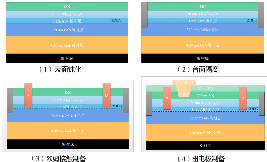
图 1 GaN 基电力电子器件基本工艺流程
