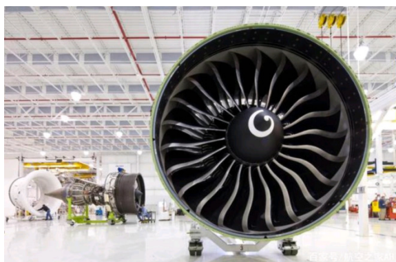
图1 GE90 发动机使用碳纤维增强复合材料设计制造风扇叶片
