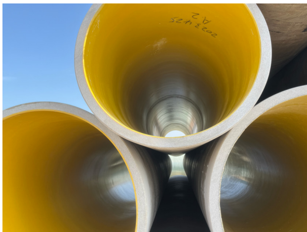
图1 离心浇铸玻璃钢夹砂管
