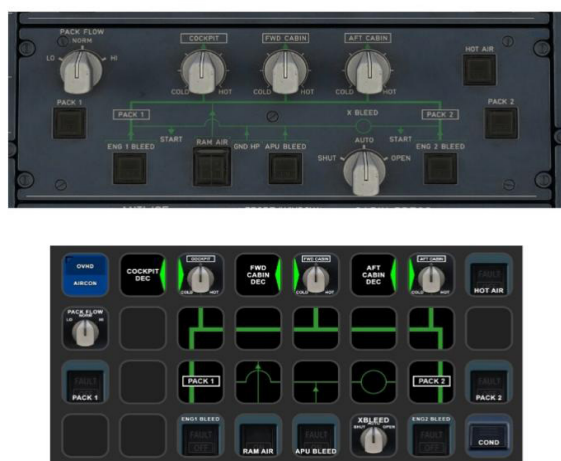
图 2 A320 飞机驾驶舱顶板上的空调面板
