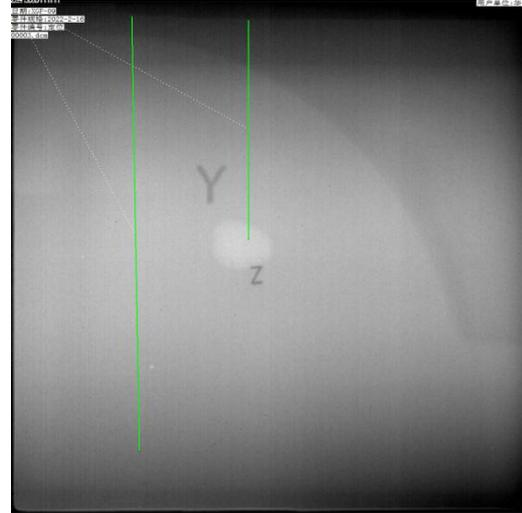
3-5 气孔影像再次在推进剂通孔中心
