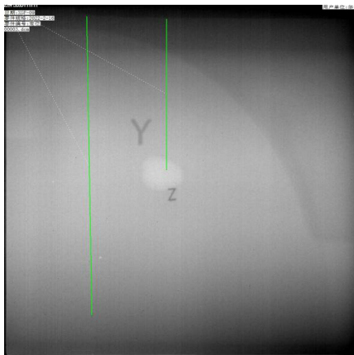
3-5 气孔影像再次在推进剂通孔中心
