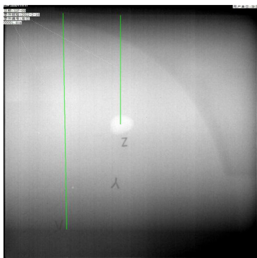
3-4 气孔影像在推进剂通孔中心
