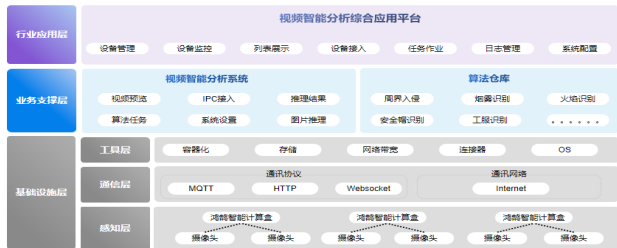
图 1 视频智能分析平台总体设计架构
