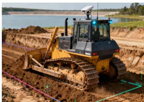
图1 智能推土机在平原水库土方开挖作业场景
