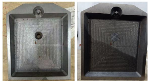
图1 铸铁模具
