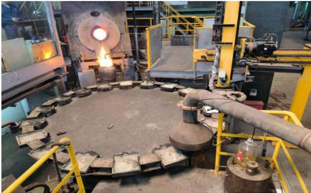
图2 中频炉银阳极板浇铸系统
