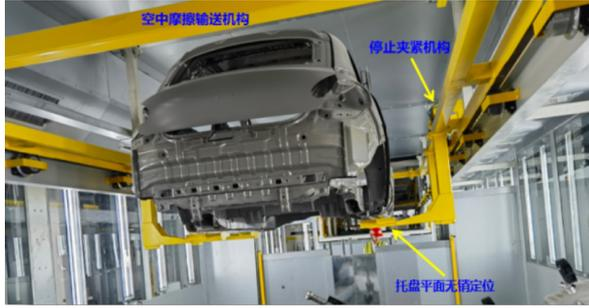
图1 空中摩擦输送机构
