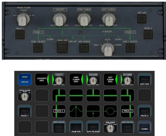
图 2 A320 飞机驾驶舱顶板上的空调面板
