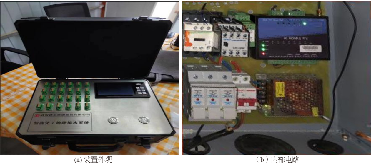
图 3 智能化降排水装置实物
