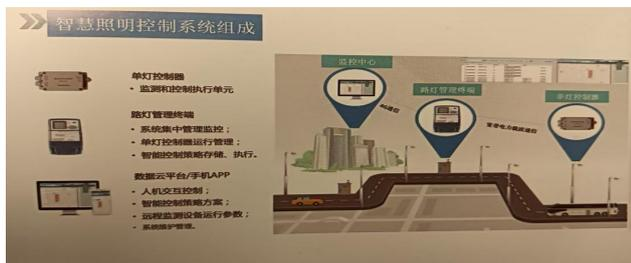
图1 智慧照明控制系统组成
